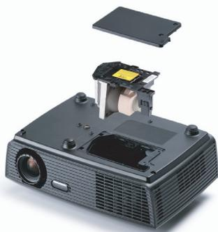
9 Ripristinare il tempo d'uso della lampada selezionando "Sì" alla voce **Ripristino lampada**, della scheda **Lampada** nel menu OSD (fare riferimento al menu **Lampada** a pagina 34). Quando si sostituisce un nuovo modulo lampada, il proiettore lo rileva automaticamente e azzerà le ore della lampada.
