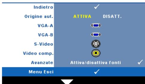
**ORIGINE AUT.**—Selezionare Disatt. (opzione predefinita) per bloccare il segnale di ingresso corrente. Se si preme il tasto **Origine** quando si imposta la modalità **Origine aut.** su **Disatt.**, è possibile selezionare manualmente il segnale di ingresso. Selezionare **Attiva** per rilevare automaticamente i segnali d'ingresso disponibili. Se
