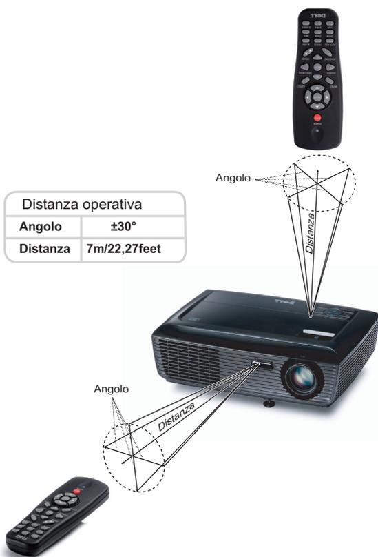
**NOTA:** La distanza operativa attuale potrebbe differire leggermente da quella dell'illustrazione. Le batterie scariche impediscono inoltre al telecomando di azionare correttamente il proiettore.
